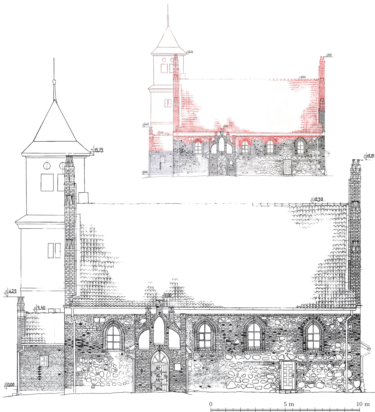
Ilustracja 6. Asuny, cerkiew pw. Zaśnięcia NMP, elewacja południowa. Pomiar wykonały Natasza Gródek i Zuzanna Iżbicka, lipiec 2023. Zb. ZAP WAPW sygn. 4413. Elewacja z zaznaczeniem zakresu prac wykonanych wg projektu F. Heitmanna
